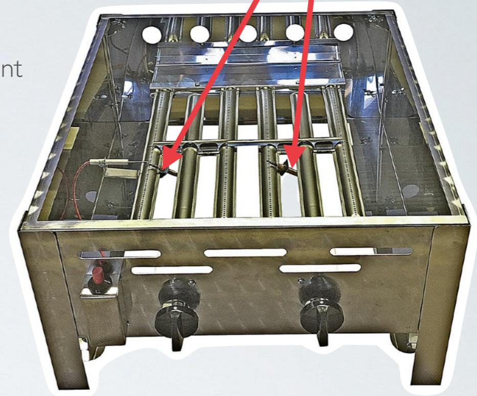
Thermoelement in Eingashahn einschrauben- leicht festziehen mit 8mm Gabelschlüssel
